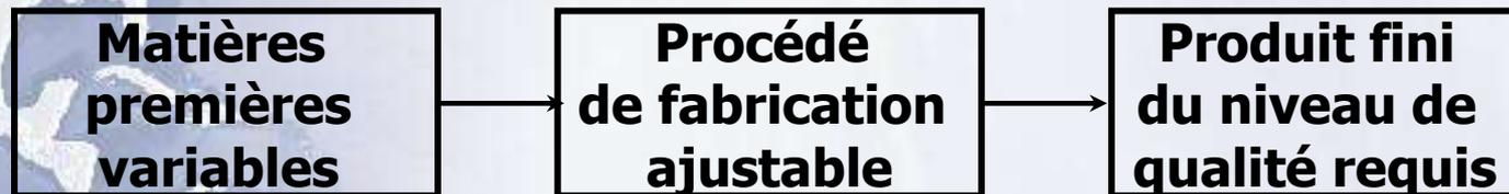
La maîtrise de la qualité du produit est fondée sur la mesure des caractéristiques du produit obtenu, les différents paramètres de contrôle du procédé étant liés entre eux, liés au pilotage du procédé de fabrication ainsi qu'aux caractéristiques du produit
