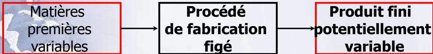
La maîtrise de la qualité du produit est fondée sur la mesure de paramètres indépendants les uns des autres, sans lien entre les paramètres du procédé et les caractéristiques du produit obtenu
